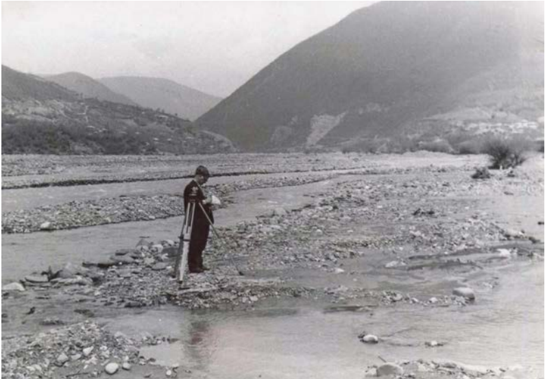
ნახ. 51. მღ. ქსანზე 1987 წ. 11 ოვნისის წყალმოვარდნის წყლის მაქსიმალური ხარჯის გაზომვები მისი გავლის შემდეგ დატოვებული ნიშნულების მიხედვით ნიველირების მეთოდით.
